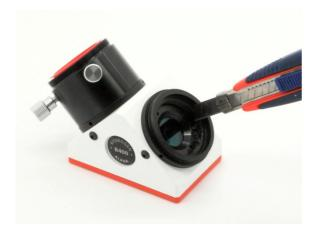
Vor dem Blau-Glas ist ein Haltering. Dieser ist zur Sicherheit mit einem oder zwei Tropfen Silikon verklebt. Entfernen Sie diese Silikontropfen vorsichtig mit einem Cutter-Messer. Wenn nötig können Sie Reste des Silikons von den Gewinderillen vorsichtig zum Beispiel mit einem kleinen Schraubendreher entfernen.
