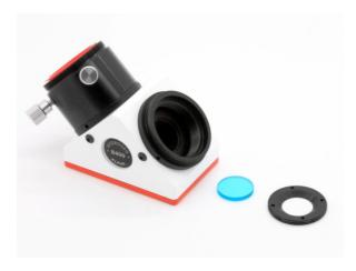
Wenn der Haltering entfernt ist lässt sich das alte Blau-Glas entnehmen. Wenn nötig können Sie nun noch Silikonreste oder Staub entfernen. Nun das neue Blau-Glas einsetzen und den Haltering wieder einschrauben.
