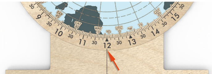
Bild 10: Die 12 Uhr-Markierungen des Nord- und Südrings müssen gleichzeitig mit den Meridianlinien fluchten.
