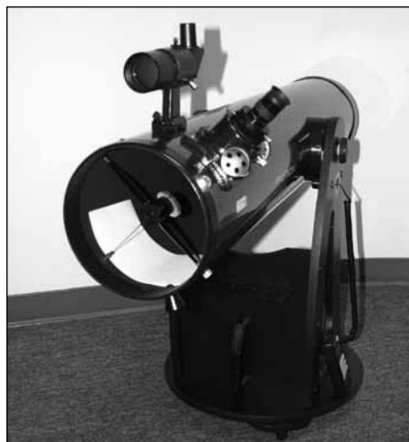
Figure 20. Le SkyQuest XT1 IntelliScope correctement installé pour la collimation. Remarquez le papier blanc placé en regard du porte-oculaire et l'angle du tube optique. Idéalement, le télescope doit être pointé sur un mur blanc.
