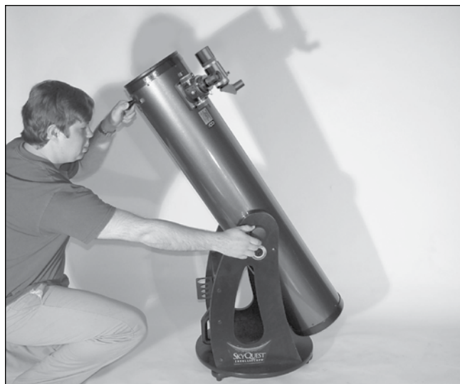
Figure 15. Ajustez la manette de réglage de la tension jusqu'à ce que l'équilibre d'altitude soit réglé. Le télescope doit se déplacer facilement en altitude sans changer de position lorsque vous le lâchez.
