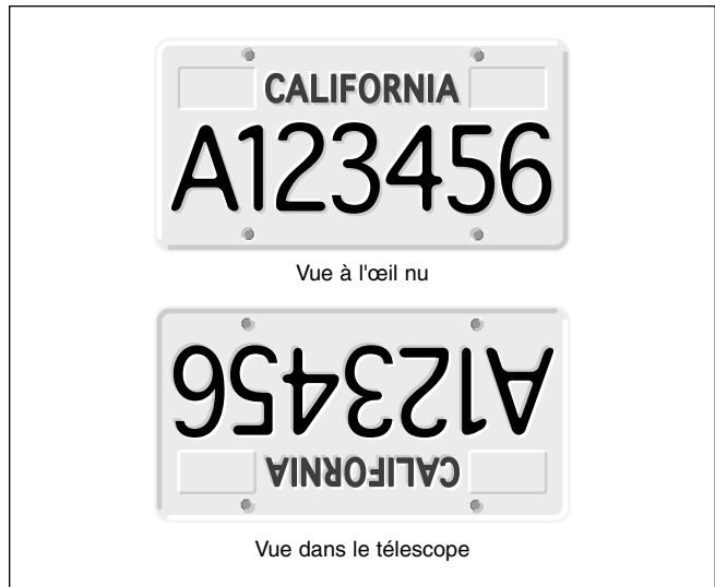
Figure 16. L'image aperçue dans un télescope à réflexion est à l'envers. C'est le cas pour les SkyQuest XT IntelliScopes.
