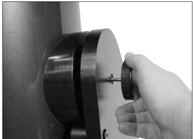
Figure 11. La manette de retenue située sur le côté droit de la base est insérée dans l'arbre en aluminium de l'alticodeur.
