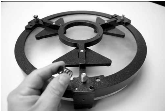
Figure 1.3. Placez les trois ressorts sur les extrémités des tiges filetées de la cellule du miroir.
