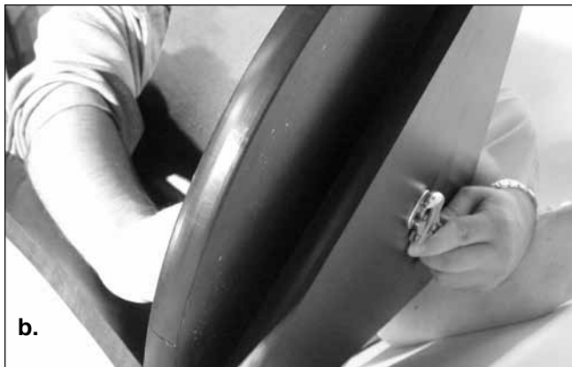
Figure 4. Pour relier les plaques inférieure et supérieure, inclinez-les légèrement, comme indiqué. Ne les placez pas de côté. (a) Utilisez une clé pour maintenir l'écrou hexagonal (b) tout en tournant l'autre extrémité de la vis de l'axe azimutal.
