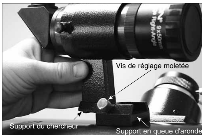
Figure 12b. Insertion du chercheur dans son support en queue d'aronde.
