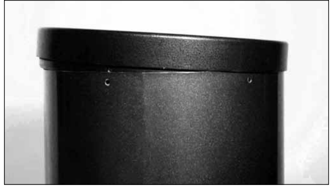
Figure 1.6. Abaissez la cellule du miroir assemblée sur le tube de sorte qu'un côté de la bague d'extrémité repose sur le bord du tube. Les trous de fixation filetés de la bague d'extrémité doivent également être alignés avec les trous traversant l'extrémité du tube.
