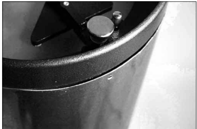
Figure 1.7. Localisez le renflement du tube qui empêche la cellule du miroir de s'insérer totalement.
