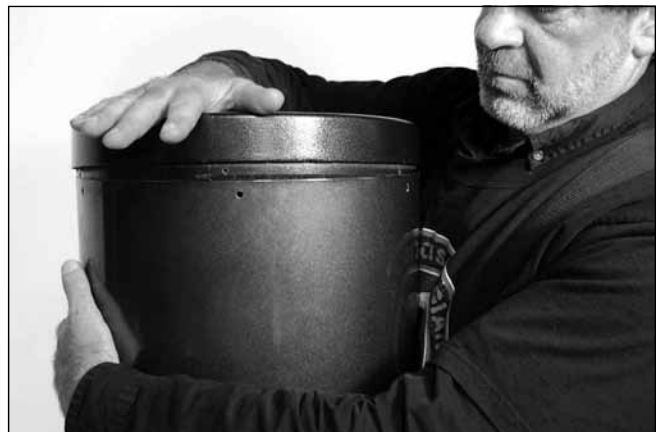
Figure 1.8. Enlancez le tube de façon à ce que votre poitrine exerce une pression contre le renflement. Poussez légèrement la cellule du miroir pour la mettre en place sur le tube.
