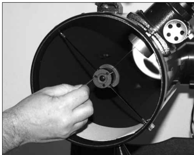
Figure 22. Ajustez l'inclinaison du miroir secondaire en desserrant ou en serrant les trois vis d'alignement à l'aide d'une clé hexagonale de 2 mm.
