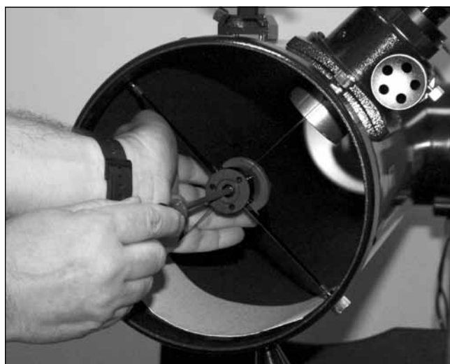
Figure 21. Pour centrer le miroir secondaire sous le porte-oculaire, maintenez le support du miroir en place d'une main tout en ajustant l'écrou central à l'aide d'un tournevis cruciforme. Ne touchez pas la surface du miroir !
