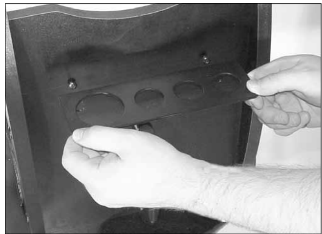
Figure 8. En utilisant les deux vis à bois fournies, installez la tablette porte-oculaires en aluminium dans les avant-trous en haut du panneau avant.
