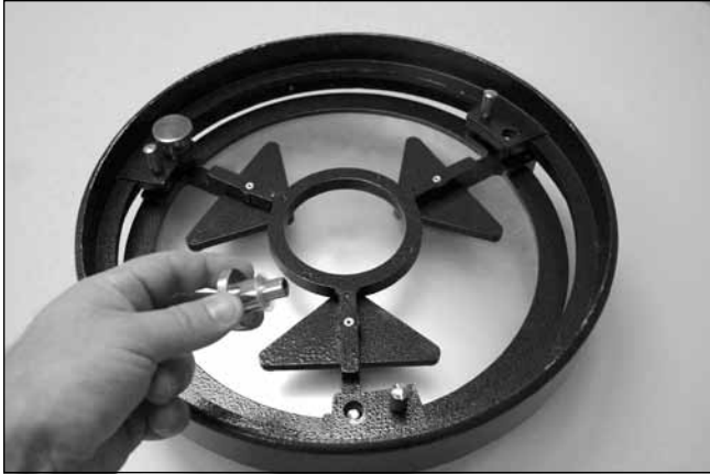
Figure 1.5. Vissez les écrous de réglage de la collimation avec des rondelles en nylon dans la bague d'extrémité arrière et sur les tiges filetées. Assurez-vous que les écrous de réglage sont engagés d'au moins trois tours complets sur les tiges.
