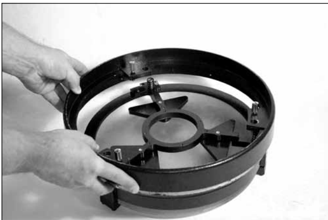
Figure 1.4. Placez la bague d'extrémité arrière sur la cellule du miroir de manière à ce que les tiges filetées la traversent et qu'elle repose sur les ressorts.
