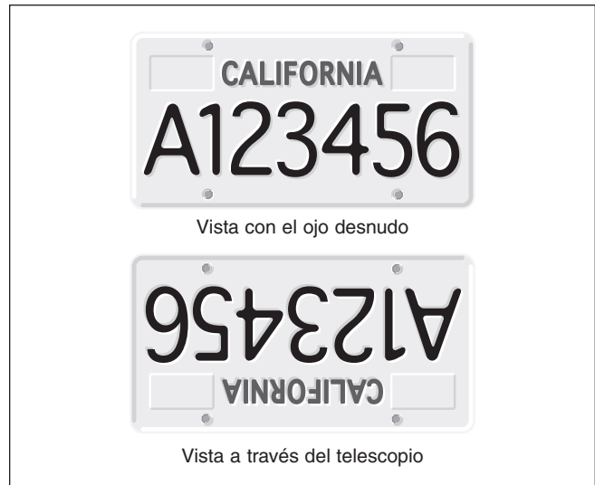
Figura 16. La vista a través de un telescopio reflector está invertida. Esto se cumple para el SkyQuest XT IntelliScope.
