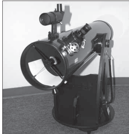
Figura 20. SkyQuest XTi IntelliScope correctamente configurado para la colimación. Fijese en el papel blanco colocado a través del enfocador y en el ángulo nivelado del tubo óptico. Lo ideal es que el telescopio apunte a una pared blanca.
