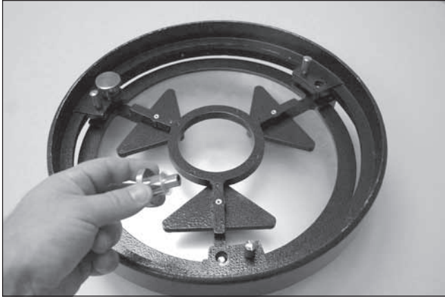
Figura 1.5. Enrosque las tuercas de mariposa de colimación, con las arandelas de nylon acopladas, a través del anillo del extremo posterior y en los ejes roscados. Asegúrese de que las tuercas de mariposa tienen por lo menos tres vueltas completas de engranaje en los ejes.
