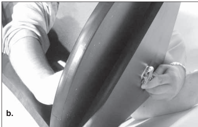
Figura 4. Para conectar las placas base, inclínelas solo ligeramente, tal como se muestra. No las coloque de lado. (a) Utilice una llave para mantener fija la tuerca hexagonal (b) mientras gira el otro extremo del tornillo del eje acimutal.
