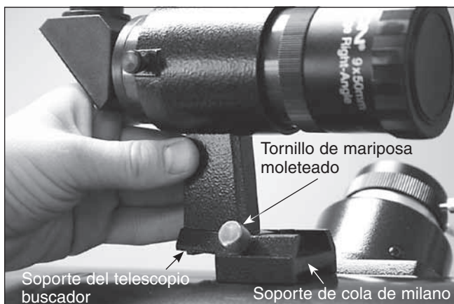
Figura 12b. Inserción del telescopio buscador en el soporte de cola de milano.
