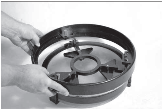
Figura 1.4. Baje el anillo del extremo posterior en la celda del espejo de manera que los ejes roscados pasen a través del anillo del extremo y el anillo del extremo descansa sobre los resortes.
