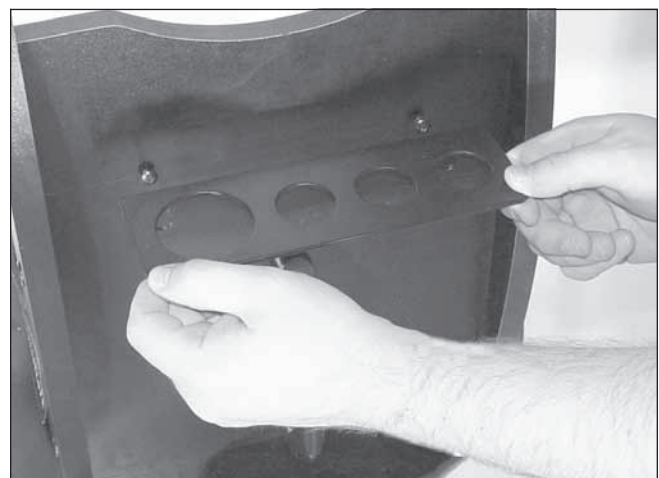
Figura 8. Usando los dos tornillos suministrados, instale el portaoculares de aluminio en los agujeros pretaladrados cerca de la parte superior del panel frontal.
