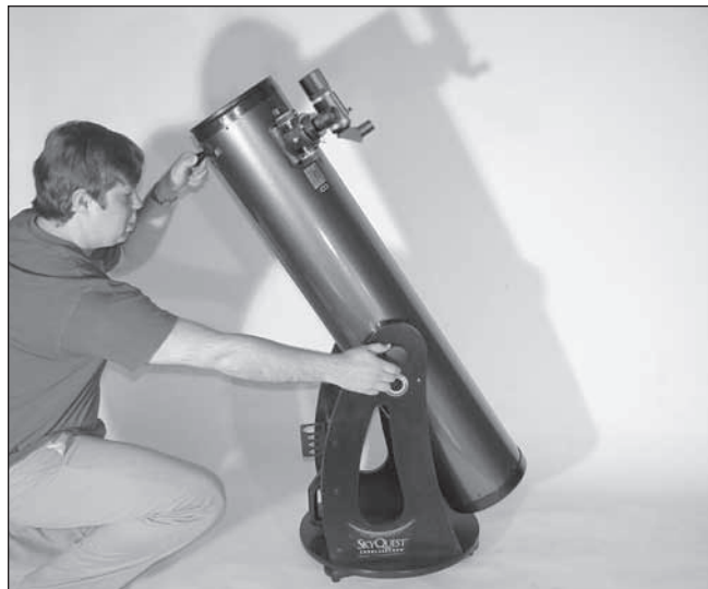
Figura 15. Ajuste el botón de tensión hasta que el equilibrio de altura sea el correcto. El telescopio debería moverse con facilidad con respecto a la altura sin que se desplace al soltarlo.
