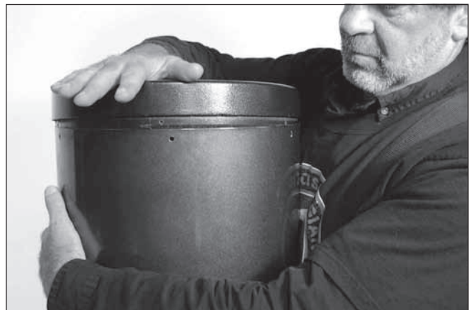
Figura 1.8. Abraza el tubo de manera que su pecho empuje la protuberancia y encaje con un golpe suave la celda del espejo sobre el tubo.
