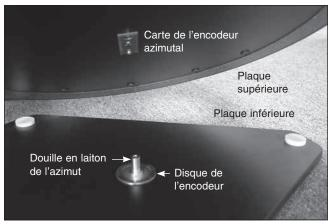
**Figure 11.** Placez la plaque supérieure sur la plaque inférieure. La douille en laiton doit passer à travers le trou au centre de la plaque supérieure (et par le grand trou de la carte de l'encodeur azimutal).
