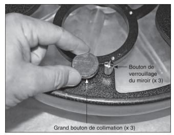
**Figure 40.** L'inclinaison du miroir principal peut être réglée en tournant un ou plusieurs des trois grands boutons de collimation.
