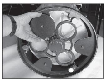
**Figure 22.** Vissez les contrepoids sur les boulons de fixation des contrepoids jusqu'à ce que chaque contrepoids soit serré contre la plaque métallique. Installez deux contrepoids sur chaque boulon de fixation.
