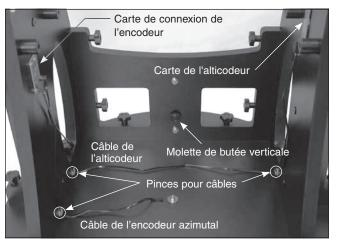
**Figure 17.** Routage de câble et placement des pinces de câble recommandés. Si vous n'avez pas l'intention de démonter la base régulièrement pour le transport, vous pouvez utiliser des pinces de câble supplémentaires.
