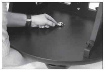
**Figure 12.** Pour relier les plaques inférieure et supérieure, inclinez-les légèrement, comme indiqué. Ne les placez pas de côté. Utilisez une clé (ou des pinces) pour maintenir la tête hexagonale du boulon de l'axe d'azimut stable tout en tournant le contre-écrou hexagonal avec une autre clé.
