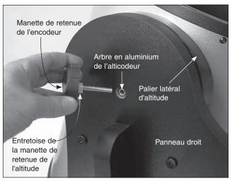
**Figure 30.** La tige de l'autre manette (la manette de retenue) s'insère dans l'arbre creux en aluminium de l'alticodeur et se visse dans l'autre palier latéral d'altitude sur le tube. Assurez-vous de mettre la rondelle en nylon blanc sur la tige avant de visser.
