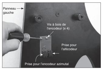
**Figure 14.** Fixez la carte de connexion de l'encodeur au panneau latéral gauche avec quatre des vis à bois pour l'encodeur et quatre rondelles de carte de connexion de l'encodeur.
