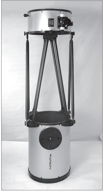
**Figure 25.** Lorsque le tube optique est monté, la section supérieure du tube doit être orientée par rapport à la section inférieure du tube, comme illustré. Remarquez l'orientation du porte-oculaire de la section supérieure du tube par rapport à la section inférieure du tube.
