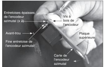
**Figure 9.** Pour installer la carte de l'encodeur azimutal, insérez une vis de fixation de la carte de l'encodeur à travers le trou allongé de la plaque. Ensuite, placez deux rondelles épaisses et une fine rondelle de l'encodeur sur la vis. Maintenant, insérez le connecteur modulaire sur la carte de l'encodeur dans le trou carré de la plaque supérieure et serrez la vis dans l'avant-trou à l'aide d'un tournevis cruciforme.
