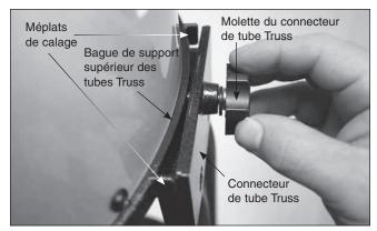
**Figure 27.** Lorsque la molette du connecteur du tube est serrée, elle maintient le connecteur contre les méplats de calage sur la bague de support supérieur des tubes.
