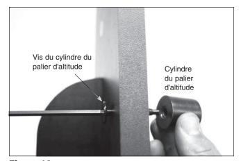
**Figure 13.** Placez une vis du cylindre du palier contre le panneau latéral et serrez la vis du cylindre du palier d'altitude. L'extrémité biseautée du cylindre doit être orientée vers l'extérieur.
