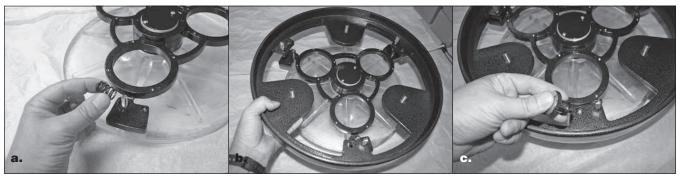
Figure 20. a) Placez les trois ressorts sur les extrémités visibles des tiges filetées du barillet du miroir. (b) Placez la bague d'extrémité arrière sur le barillet du miroir de manière à ce que les tiges filetées la traversent et qu'elle repose sur les ressorts. (c) Vissez les boutons de collimation, accompagnés de rondelles en nylon, sur les tiges filetées et à travers la bague d'extrémité arrière. Assurez-vous que les boutons sont engagés d'au moins trois tours complets sur les tiges.
