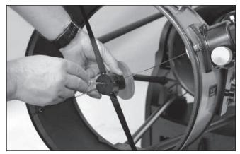
**Figure 38.** Pour centrer axialement le miroir secondaire sous le porte-oculaire, maintenez le support du miroir en place d'une main tout en ajustant la vis centrale à l'aide d'un tournevis cruciforme.
