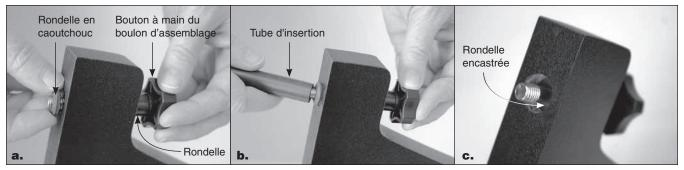
**Figure 8. (a)** Placez une rondelle en caoutchouc sur l'extrémité filetée du boulon d'assemblage et enfoncez-la au maximum avec les doigts. **(b)** Poussez ensuite la rondelle à l'aide du tube d'insertion au-delà du filetage jusqu'au trou chambré dans le bois.
