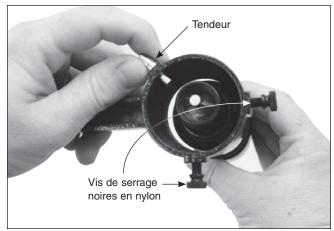
**Figure 31.** Tirez sur le tendeur et faites glisser le chercheur dans son support jusqu'à ce que le joint torique soit logé dans le renfoncement à l'avant du support.
