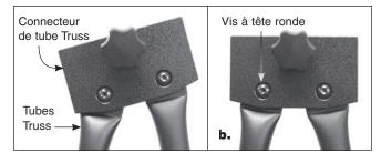
**Figure 26.** La position des connecteurs par rapport aux extrémités des tubes peut être ajustée pour que les connecteurs et la bague de support supérieur des tubes coïncident.
