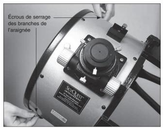
**Figure 39.** Pour centrer radialement le miroir secondaire dans le tube télescopique du porte-oculaire, faites des ajustements sur les deux écrous de serrage des branches de l'araignée qui sont perpendiculaires au porte-oculaire.
