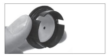
**Figure 36.** L'"œilleton de collimation rapide" est percé en son centre centre et a une surface interne réfléchissante.
