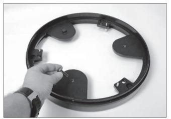
**Figure 19.** Vissez les trois boulons de fixation de contrepoids dans les trous de la bague d'extrémité arrière et serrez-les fermement avec une clé.
