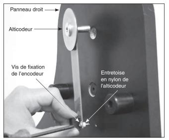
**Figure 15.** Pour installer l'alticodeur sur la surface intérieure du panneau de droite, insérez deux vis à bois pour la carte de l'encodeur dans les trous allongés de la carte. Ensuite, ajoutez une entretoise en nylon de l'alticodeur à chaque vis. À présent, insérez l'arbre de l'alticodeur à travers le trou du panneau de droite, et serrez les vis dans les deux avant-trous avec un tournevis cruciforme.
