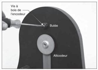
**Figure 16.** Installez la butée dans l'avant-trou au-dessus de l'alticodeur avec l'une des vis à bois de l'encodeur.
