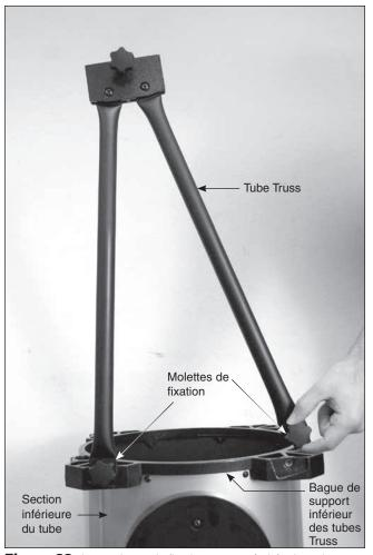
**Figure 23.** Les molettes de fixation aux extrémités des tubes Truss se vissent dans les orifices de la bague de support inférieur des tubes sur la section inférieure du tube optique.
