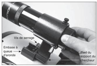
**Figure 32.** Le pied du support du chercheur se loge dans l'embase à queue d'aronde où une vis de serrage permet de le fixer.
