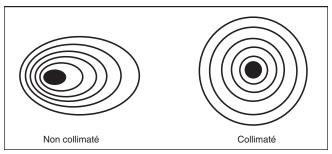
**Figure 41.** Un test sur une étoile permet de déterminer si les optiques du télescope sont correctement collimatées. Une image non mise au point d'une étoile lumineuse à travers l'oculaire doit apparaître comme illustré à droite si les optiques sont parfaitement collimatées. Si le cercle est asymétrique, comme illustré à gauche, le télescope doit être collimaté.
