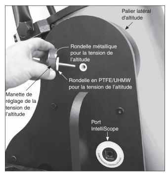
**Figure 29.** Insérez la tige de la manette de réglage de la tension de l'altitude, équipée des rondelles métallique et en PTFE / UHMW, sur le côté de la base qui présente le port IntelliScope, et vissez-la dans le palier latéral d'altitude du tube.
