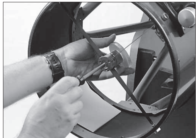
Figura 30. Per centrare lo specchio secondario sotto il foceggiatore, mantenere in posizione il supporto dello specchio secondario con una mano mentre si regola il bullone centrale con un cacciavite a croce. Non toccare la superficie dello specchio!
