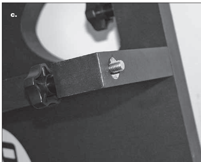
Figura 9. a) Posizionare una rondella in gomma sul lato filettato del bullone di fissaggio e spingerla il più possibile con le dita. b) Utilizzare quindi il tubo di inserimento in dotazione per spingere la rondella oltre la filettatura e dentro il foro svasato nel legno. c) Lo scopo della rondella incassata è mantenere il bullone fermo nel foro.
