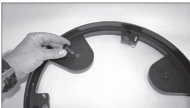
Figura 15. Avvitare i tre bulloni di montaggio a testa esagonale dei contrappesi (solo XX14g e XX16g) nei fori delle piastre di supporto dei contrappesi, come illustrato. Stringere con una chiave a mezzaluna da 16 mm o regolabile.
