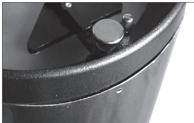
Figura 17. Individuare l'area sporgente del tubo che impedisce l'inserimento dell'anello di chiusura. Premere su questo rigonfiamento affinché l'alloggiamento dello specchio si incastri nel tubo. Fare attenzione a non schiacciare le dita.
