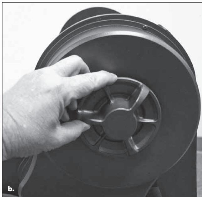
Figura 34. a) Gli alloggiamenti riprogettati del motore/encoder per l'altitudine (Alt) e l'azimut (AZ) del telescopio Dobson XXg sono dotati di grandi manopole a frizione manuale per regolare la resistenza al movimento. b) Ruotare la manopola a frizione per regolare l'attrito del movimento quando si ruota il telescopio a mano.
