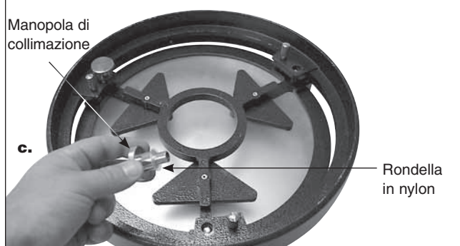
Figura 16. Per modello XX12g. a) Posizionare le tre molle sui perni filettati esposti dell'alloggiamento dello specchio. b) Abbassare l'anello di chiusura posteriore sull'alloggiamento dello specchio in modo che i perni filettati attraversino l'anello, che deve appoggiare sulle molle. c) Infilare le manopole di collimazione, con le rondelle in nylon inserite, sui perni filettati attraverso l'anello di chiusura posteriore. Assicurarsi di serrare le manopole di almeno tre giri completi sui perni.
