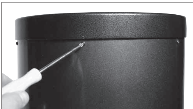
Figura 14. Per rimuovere l'anello di chiusura posteriore, svitare le viti che lo fissano al tubo.
