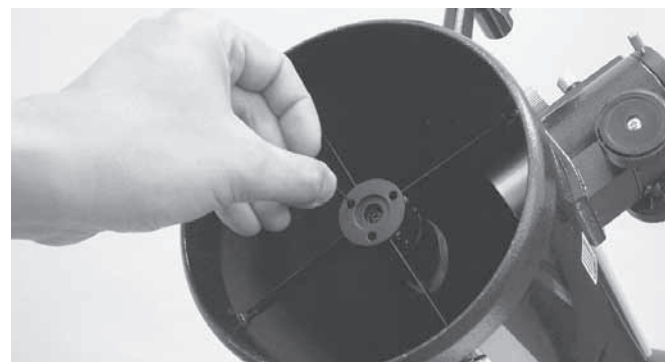
Abbildung 16. Stellen Sie mit einem Innensechskantschlüssel (2 mm) die Neigung des Sekundärspiegels durch Lockern bzw. Anziehen der drei Stellschrauben für die Sekundärspiegelausrichtung ein.
