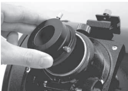
Abbildung 22a. Entfernen Sie zunächst wie in der Abbildung gezeigt den 1,25- und den 2-Zoll-Adapter (32 mm / 51 mm).
