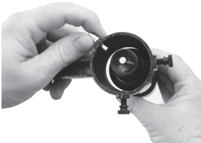
Abbildung 3b. Ziehen Sie die Spannvorrichtung zurück, und schieben Sie das Sucherfernrohr so in die Halterung, dass der O-Ring in der Halterung verschwindet.
