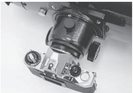
Abbildung 22c. Das SkyView Pro 8 EQ-Teleskop mit montierter 35-mm-Spiegelreflexkamera.
