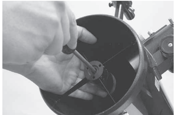
Abbildung 15. Zum Zentrieren des Sekundärspiegels unter dem Fokussierer halten Sie den Spiegelhalter mit einer Hand fest, während Sie die mittlere Schraube mit einem Kreuzschlitz-Schraubendreher festziehen. Berühren Sie keinesfalls die Spiegeloberfläche!
