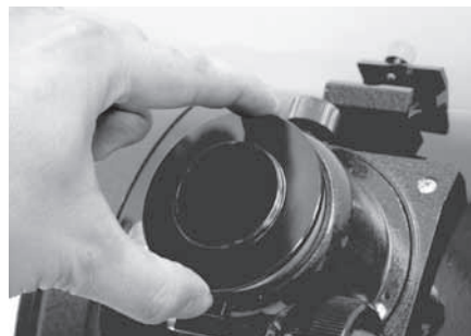
Abbildung 22b. Befestigen Sie den Kameraadapter am Okularauszug des Fokussierers.
