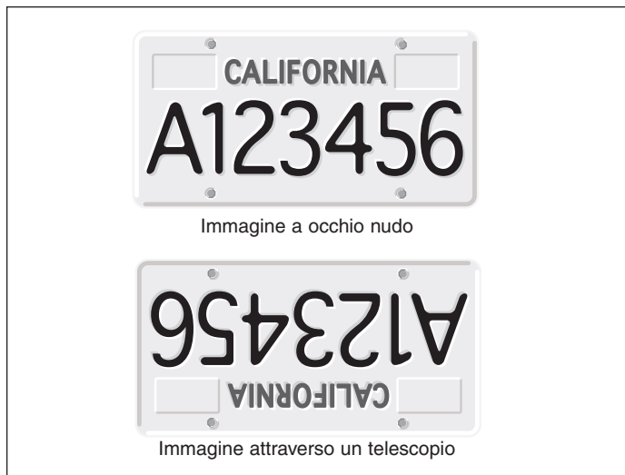
Figura 11. L'immagine attraverso un telescopio riflettore risulta capovolta.
