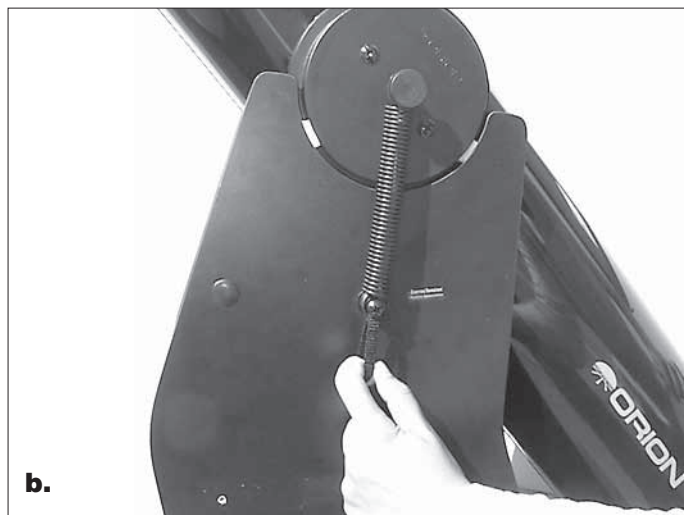
Figura 8. (a) Per fissare la molla alla base, afferrare l'asola con il dito indice e tirare la molla verso il basso. (b) Mentre si tira verso il basso, fare scivolare l'anello all'estremità della molla sulla testa della vite e rilasciare l'asola una volta che l'anello è appoggiato sulla parte stretta del distanziale in nylon.
