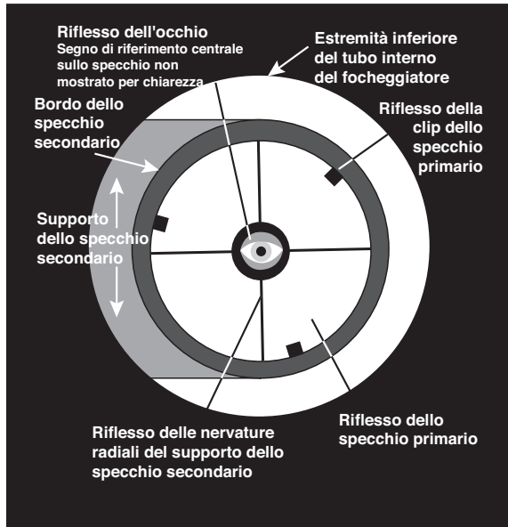
Figura 13. Collimazione delle ottiche. (a) Se gli specchi sono allineati correttamente, l'immagine attraverso il tubo interno del focheggiatore dovrebbe assomigliare a quella illustrata. (b) Con il tappo di collimazione applicato, se l'ottica non è allineata, l'immagine potrebbe assomigliare a quella illustrata. (c) In questo caso lo specchio secondario è centrato sotto il focheggiatore, ma deve essere regolato (inclinato) in modo che l'intero specchio primario sia visibile. (d) Lo specchio secondario è allineato correttamente, ma lo specchio primario ha ancora bisogno di regolazione. Quando lo specchio primario è allineato correttamente, il punto risulta centrato, come in (e) .
