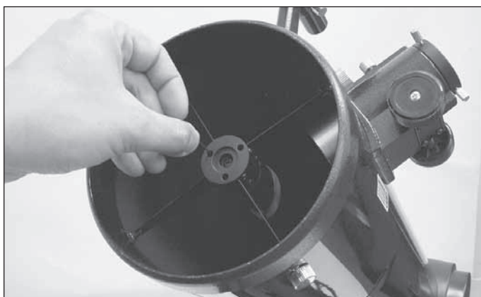
Figura 15. Regolare l'inclinazione dello specchio secondario allentando o stringendo le tre viti di allineamento con una chiave esagonale da 2 mm.
