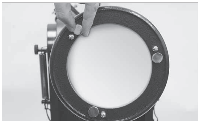
Figura 17. È possibile regolare l'inclinazione dello specchio primario girando una o più delle tre viti zigrinate più grandi.
