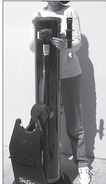
Figura 3. Ajuste el tubo óptico de la "cuna" de la base de manera que los rodamientos laterales de altura del tubo se apoyen sobre las "almohadillas" de plástico blanco y el buscador apunte hacia fuera del soporte delantero (pieza B).
