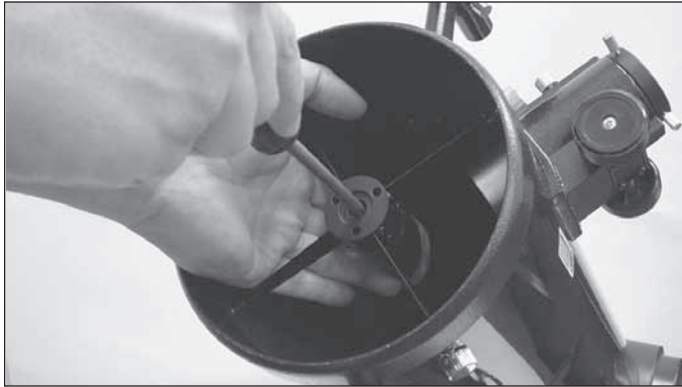
Figura 14. Para centrar el espejo secundario bajo el enfocador, sostenga el soporte del espejo secundario en su lugar con una mano mientras ajusta el perno central con un destornillador Phillips. No toque la superficie del espejo.
