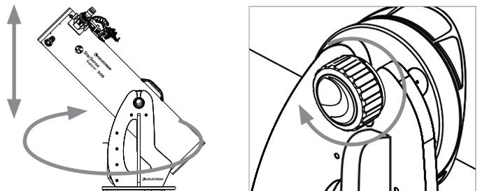
1. Das StarSense Dobson Teleskop bewegt sich frei in Höhe (auf und ab) und Azimut (von links nach rechts). Sie bewegen einfach den Tubus, indem Sie ihn in die gewünschte Richtung schieben. Sie können den Knopfgriff an der Vorderseite des Teleskops als Handgriff verwenden.
