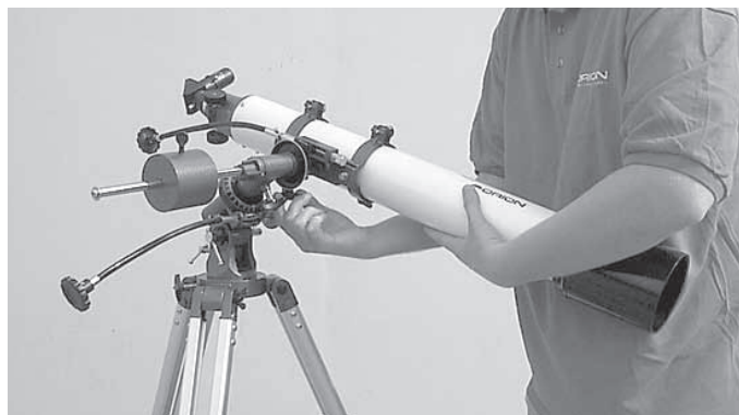
Figura 3c. Preparazione del telescopio per il bilanciamento sull'asse di declinazione allentando innanzitutto la manopola di blocco della declinazione.
