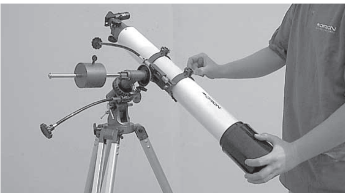
Figura 3d. Bilanciamento del telescopio rispetto all'asse di declinazione. Come nella figura, il telescopio è sbilanciato (inclinato).
