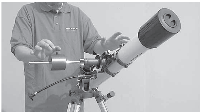
Figura 3b. Il telescopio ora è in equilibrio sull'asse dell'ascensione retta, ossia quando le mani lasciano la presa, la barra di contrappeso rimane orizzontale.
