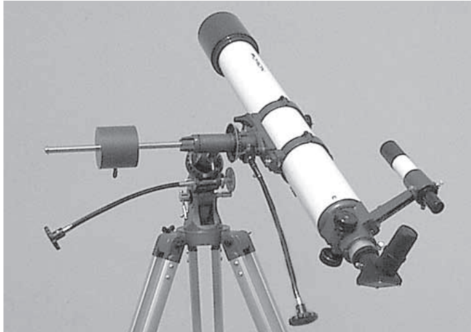
Figura 6a. Telescopio puntato a sud. Da notare che in tutte queste illustrazioni la montatura e il treppiede rimangono immobili, mentre vengono spostati solo gli assi dell'ascensione retta e di declinazione.
